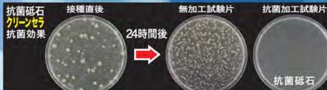
写真は試験片(#1000中砥石)試験菌株(大腸菌)での抗菌性試験(フィルム密着法)の電子顕微鏡写真データです。
