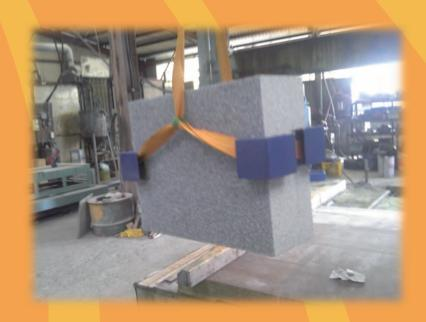
「スリングクランプ」とは、有効長さの対象物なら簡単に吊上げできるクランプです。 一人で簡単にセットでき、あとはクランプと同様に持ち上げるだけ!
